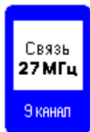
7.16 "Зона радиосвязи с аварийными службами". Участок дороги, на котором действует система радиосвязи с аварийными службами в гражданском диапазоне 27 МГц.
